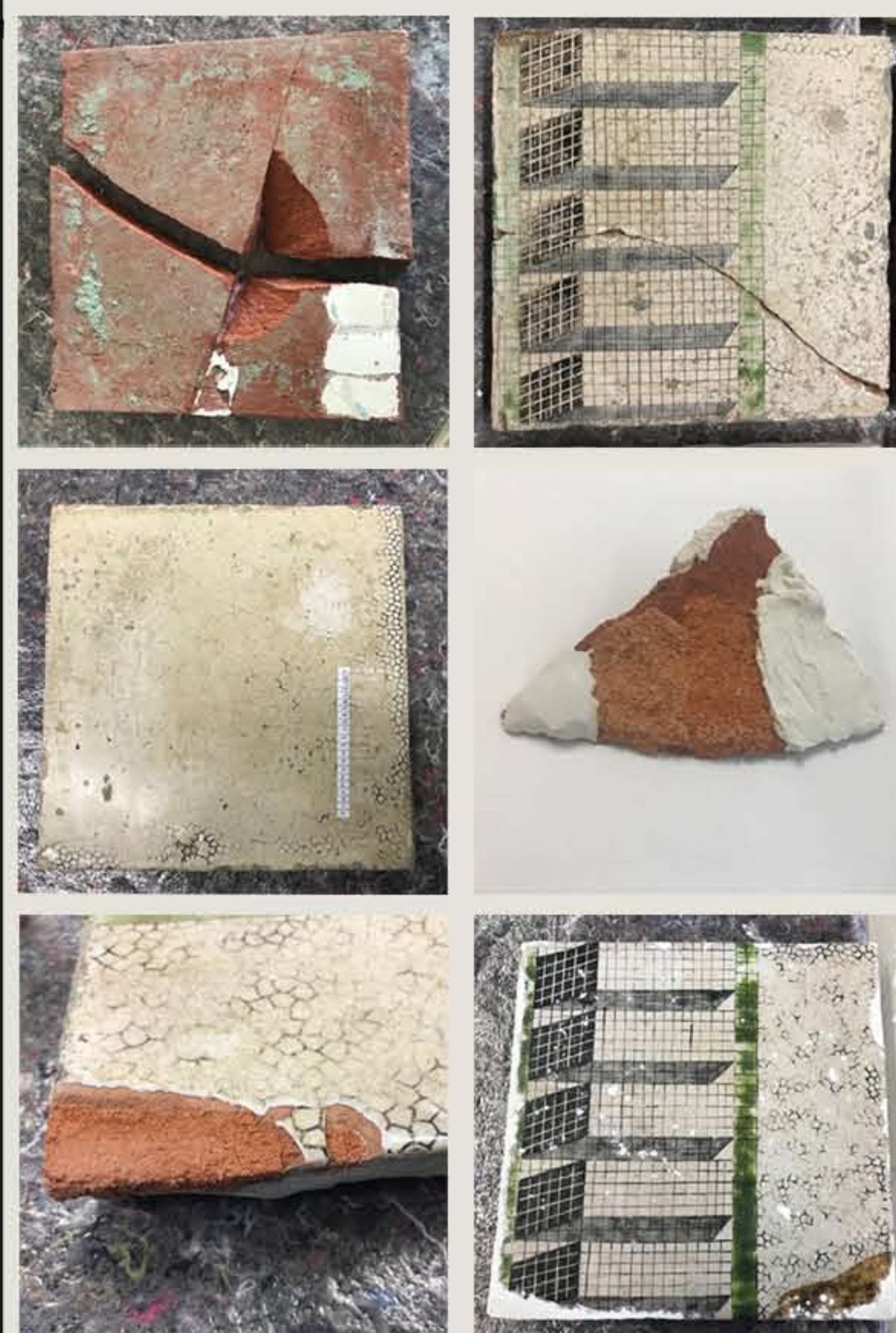
Abb. 5 - 10: oben li: Probekörper, oben re: geklebte Fliese, Mitte li: Reinigungsproben, Mitte re: Probe Ergänzungsmassen, unten li: Ergänzung Scherben, unten re: Ergänzung Glasur
