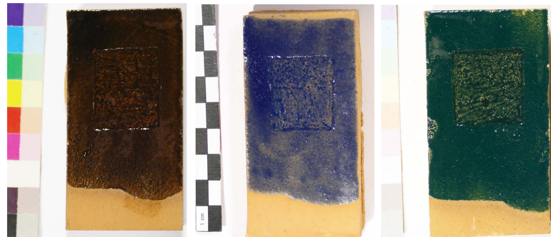
Abb.5 bis 7: Mit ORG behandelte große Prüfkörper der Testreihe 2 nach der Trocknung
